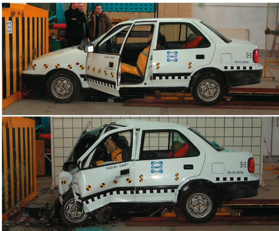
Rys. 2. Zestawienie sylwetek Suzuki Swift przed i po przeprowadzeniu testu przy prędkości ok. 87 km/h
