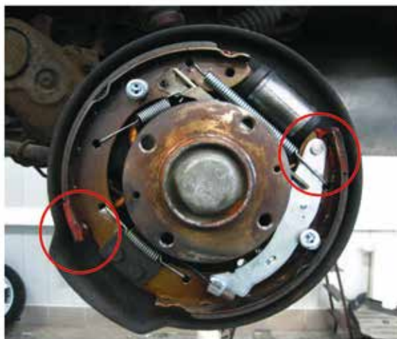
Rys. 4. Hamulec bębnowy samochodu Citroen Berlingo z zabudowanym układem do ograniczania emisji pyłów (kolorem czerwonym zaznaczono elementy ssące)
