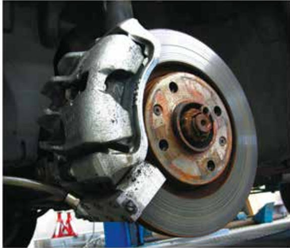
Rys. 3. Hamulec tarczowy samochodu Citroen Berlingo z zabudowanym układem do ograniczania emisji pyłów
