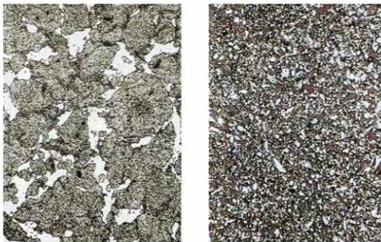
Rys. 9. Pył z próbki z hamulca tarczowego, obraz powiększony 76 razy (z prawej) i 910 razy (z lewej)
