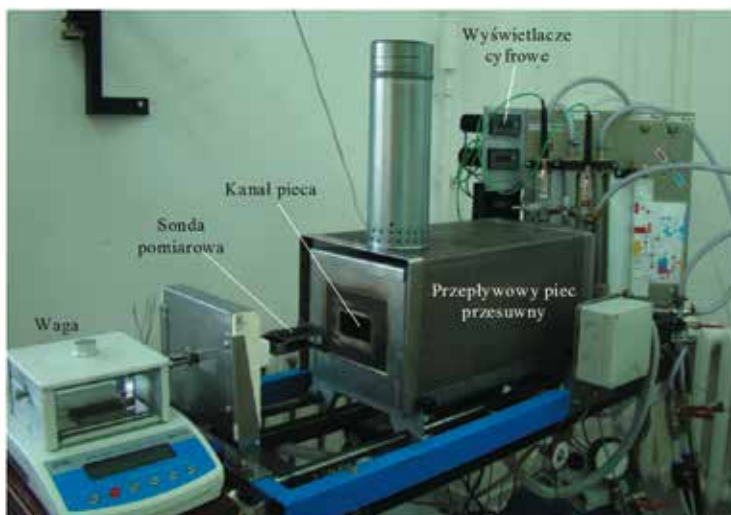
Rys. 2.1. Widok ogólny stanowiska do gravimetrycznych badań kinetyki utleniania PM [16]
