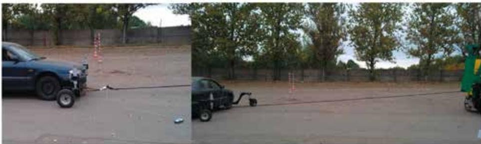
4 pav. Tempimo bandymas išilginio ir skersinio sukibimo įvertinimui
