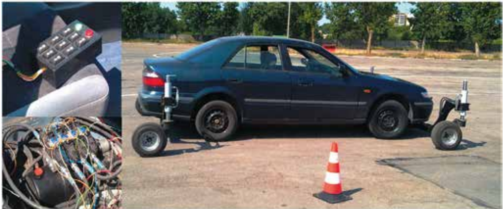
1 pav. Automobilis su sumontuota slydimo sistema ir sistemos valdymo pultas su 12 V hidrauline stotele
