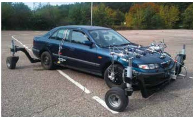
5 pav. Automobilis su sumontuota slydimo sistema ir dinaminių parametų matavimo įranga
