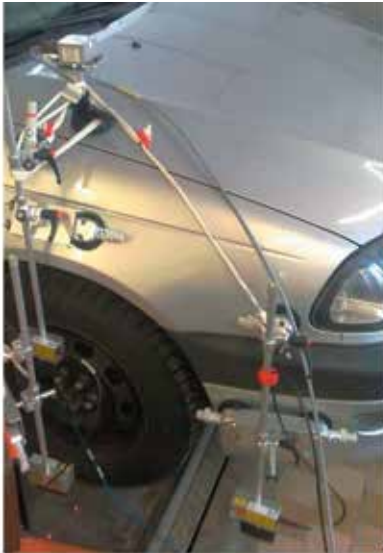
2 pav. Kairėje – amortizatorių efektyvumo matavimas stende „Safeline 400/800“. Dešinėje – Automobilio pakabos eigos matavimas
