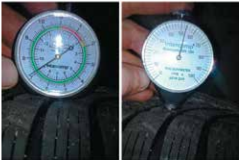
3 pav. Žieminės padangos protektoriaus gylis ir gumos kietumas
