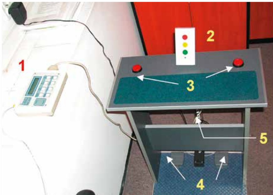
Rys. 1. Miernik czasu reakcji MCR - 2001E, 1 - jednostka centralna MCR - 2001 E - mikroprocesorowy miernik czasu reakcji, 2 - semafor (sygnalizator - wyzwalacz bodźców świetlnych i bodźca dźwiękowego), 3 - manipulatory „ręczne”, 4 - manipulatory „nożne”, 5 - układ przyłączeniowy
