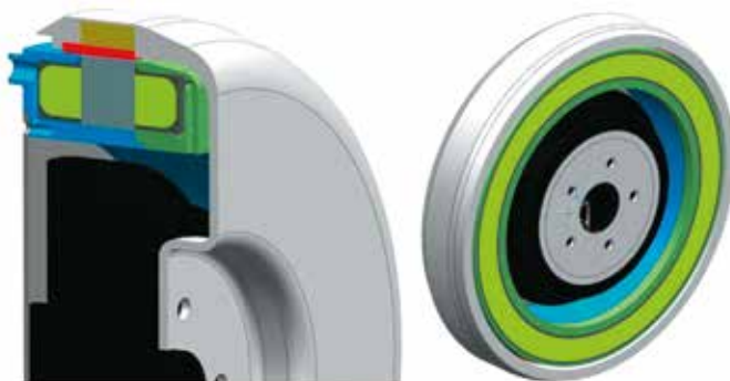
Rys. 1. Koncepcja silnika w piaście
