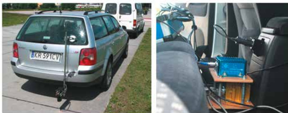
Rys. 1, 2. Widok samochodu badawczego VW Passat oraz aparatury pomiarowej VBox i Crossbow zamontowanej wewnątrz samochodu
