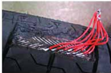
Rys. 13. Opona przygotowana do pomiarów deformacji z wykorzystaniem właściwości sensorycznych jej struktury [19]
