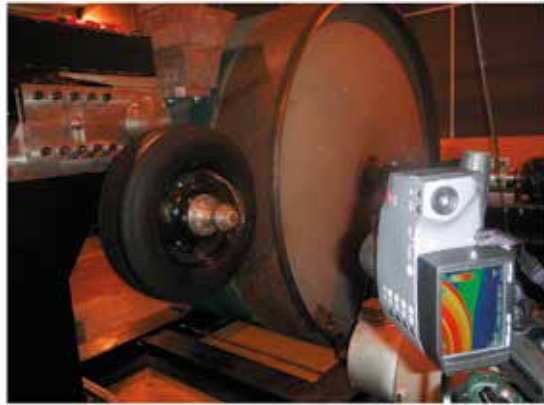
Rys. 3. Maszyna bieżna z bębnum zewnętrznym o średnicy 2.0 m
