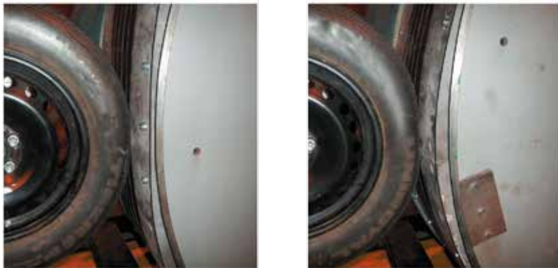
Rys. 4. Minimalne (z lewej) i maksymalne (z prawej) ugięcie dynamiczne opony toczącej się po repliце sinusoidalnej
