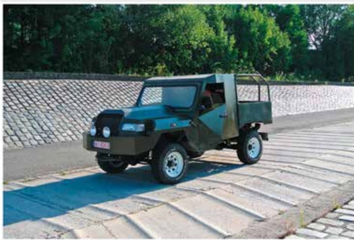
Rys. 2. Samochód SOF podczas próby wybiegu na nawierzchni sinusoidalnej [8].
