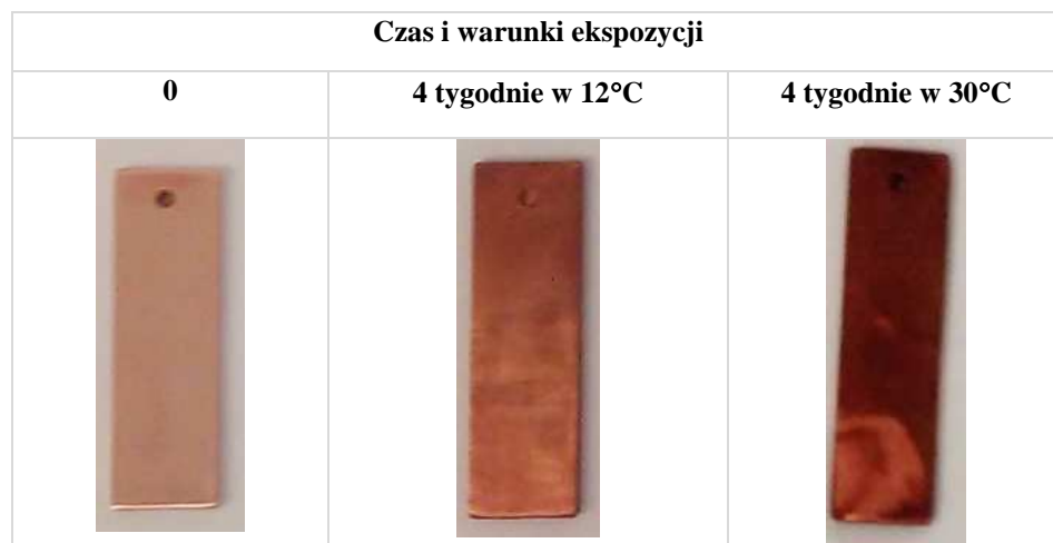
Rys. 3 Wygląd płytek miedzianych przed i po ekspozycji w oleju napędowym
