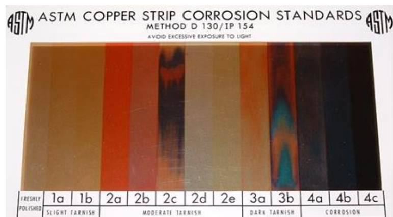
Rys. 1 Wzorce korozji przytaczane przez normę PN-EN ISO 6251, według których określany może być stopień korozji płytki miedzianej
