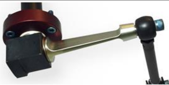
Rys. 9. Przedni stabilizator o regulowanym ramieniu [8].
