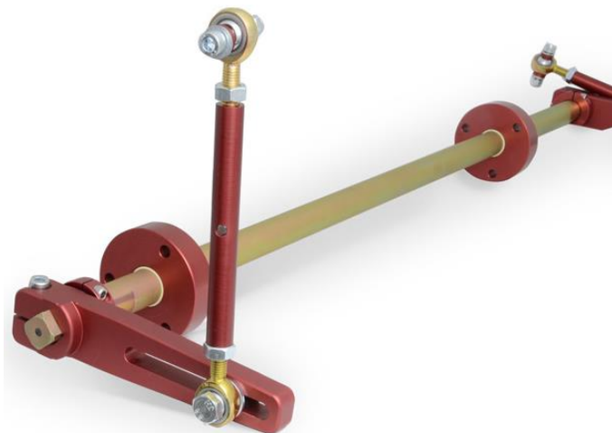
Rys. 8. Stabilizator osi przedniej o regulowanym ramieniu [6].
