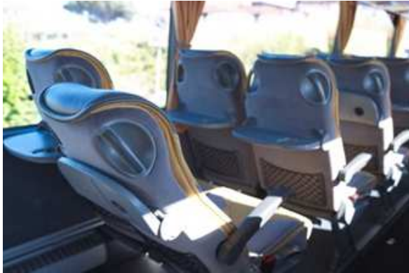
Rys. 1. Stoliki mocowane do oparcia foteli autobusu [13]
