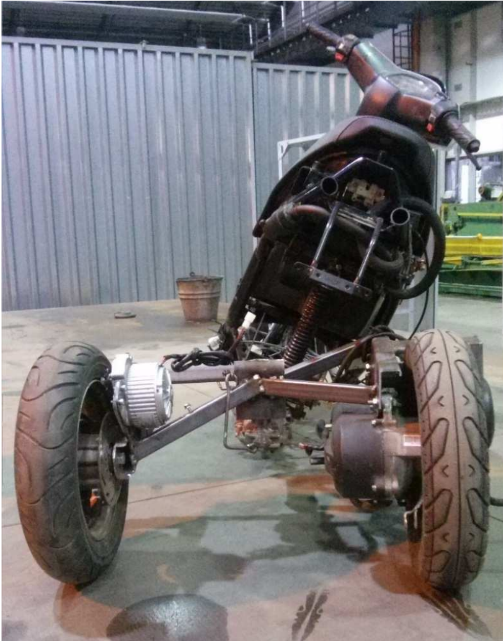
Rys. 5. Drugi prototyp trójkołowego pojazdu w pozycji maksymalnego pochyłu nadwozia. [źródło: własne]
