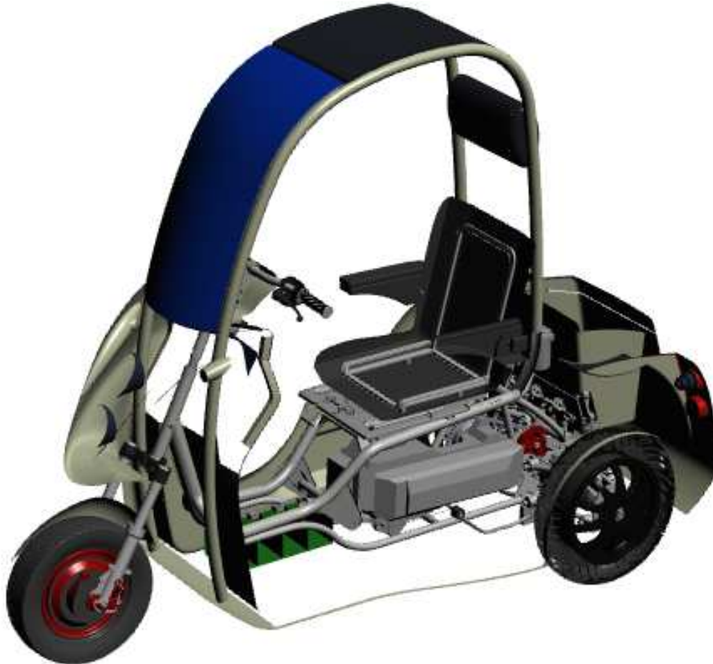
Rys. 2. Model CAD pojazdu inwalidzkiego trójkołowego z zawieszeniem niezależnym. [źródło: własne]
