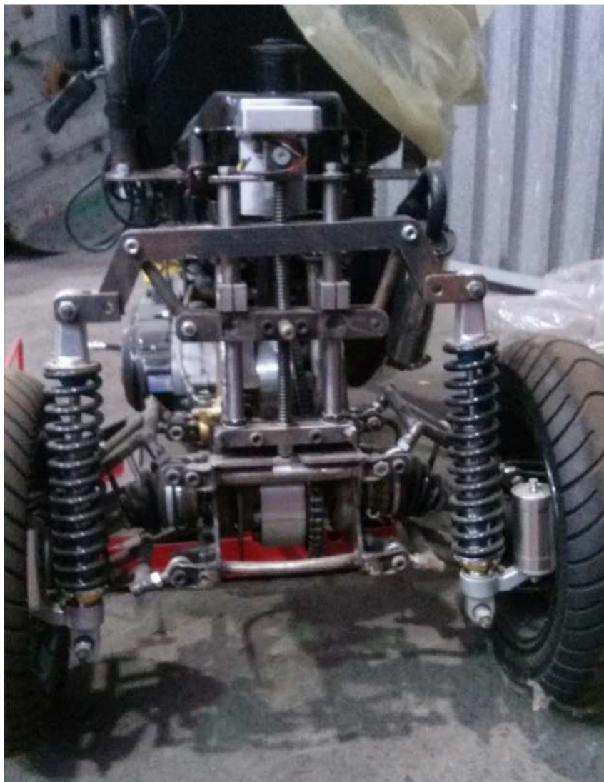
Rys. 1. Pojazd trójkołowy z niezależnym zawieszeniem kół tylnych.
