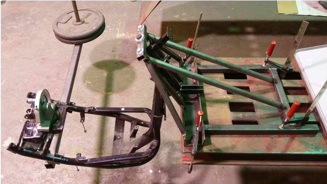
Rys. 14. Stanowisko do badania sztywności skrętej ramy pojazdu trójkołowego. Wprowadzanie momentu skręcającego polegało na zadawaniu siły wynikające z masy ciężarów przykładanych na ramieniu 1m od osi ramy. Kąt skręcenia ramy odczytywany był przy użyciu kątomierza umieszczonego w płaszczyźnie skręcania ramy momentem pochodzącym od obciążenia ciężarami.
