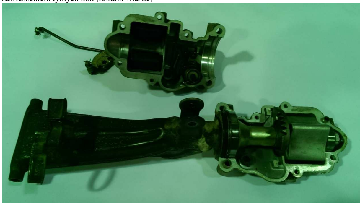
Rys. 4. Wahacz obrotowy stosowany w motocyklu Honda Gyro. [źródło: własne]
