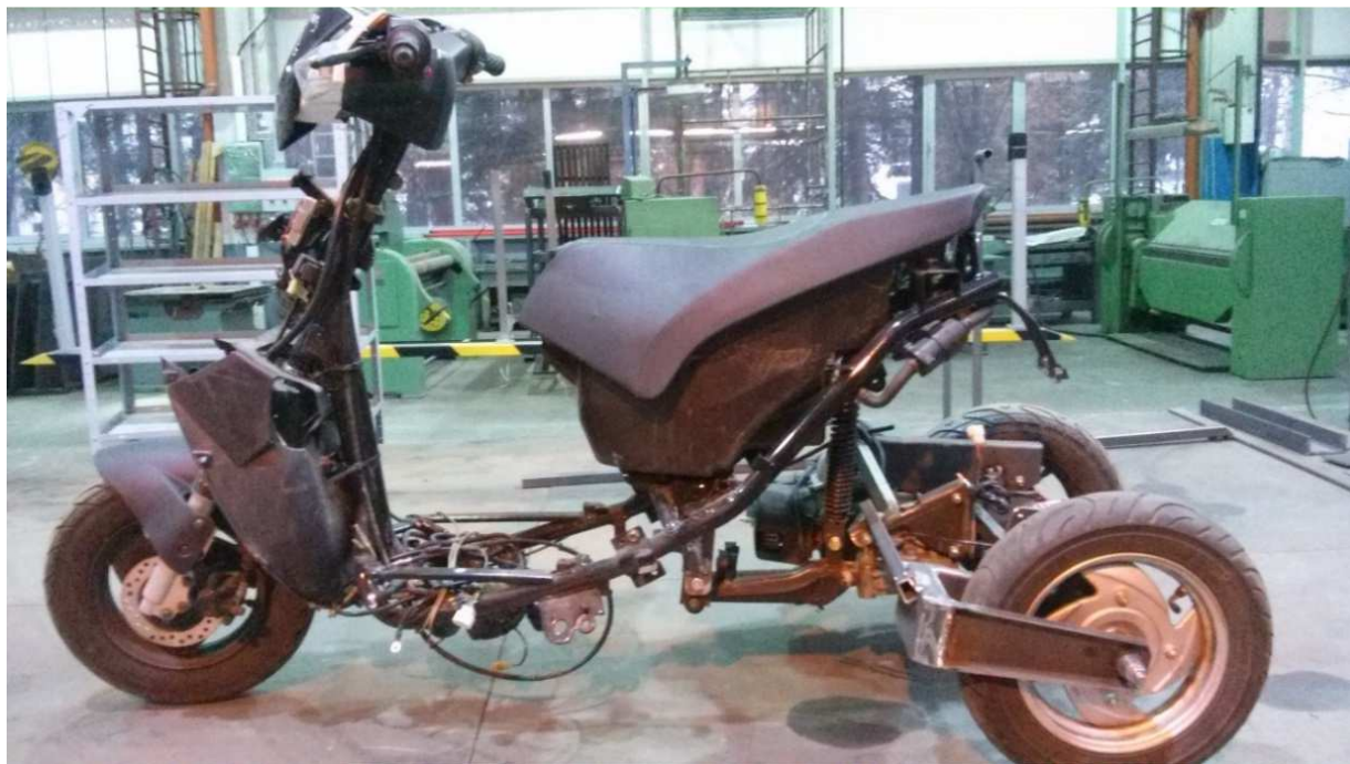
Rys. 3. Drugi prototyp trójkołowego pojazdu inwalidzkiego z zależnym zawieszeniem tylnych kół. [źródło: własne]
