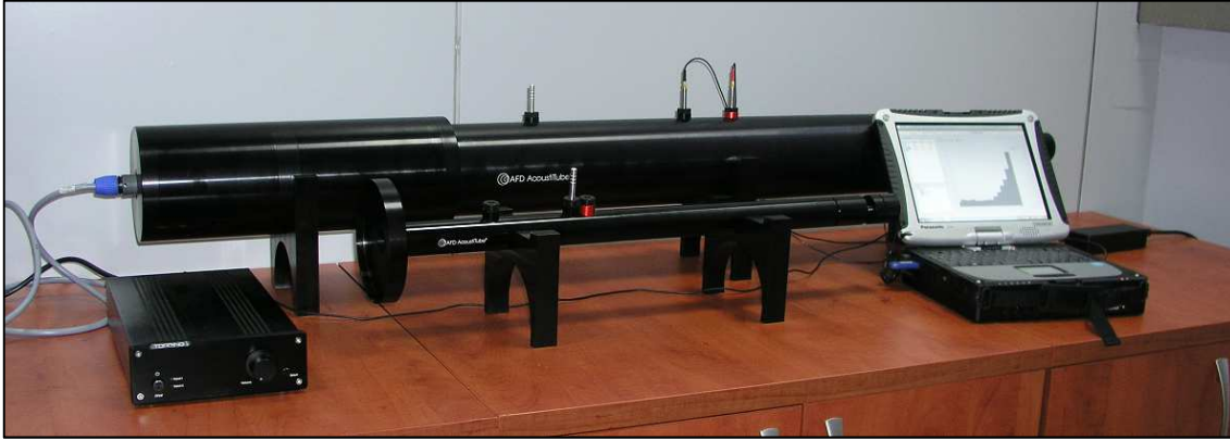
Rys. 2 Stanowisko do wyznaczania współczynnika pochłaniania dźwięku – rura impedancyjna
