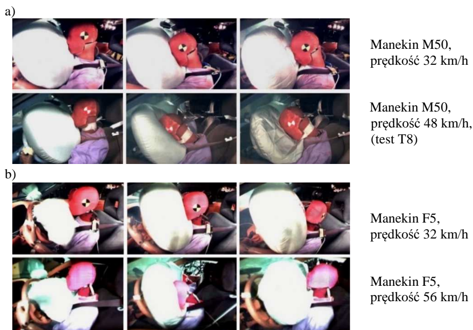
Rys. 9. Przemieszczenia manekina względem poduszki w tym samym modelu samochodu (opracowano na podst. [24]); a) manekin M50, prędkość 32 i 48 km/h; b) manekin F5, prędkość 32 i 56 km/h
