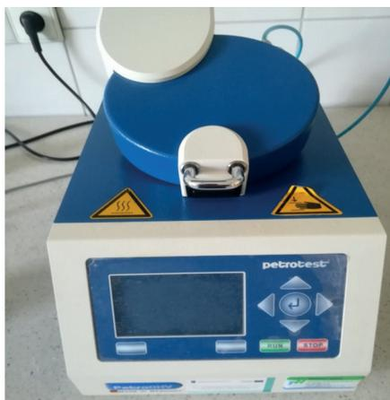
Fig. 5. PetroOxy apparatus
