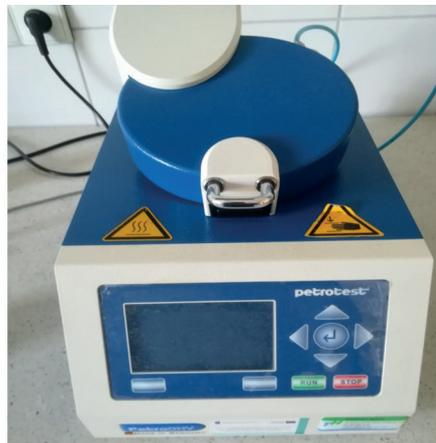
Fig. 5. PetroOxy apparatus
