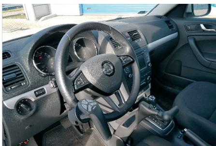
**Fig. 18. Accelerator stick (ITS)**
